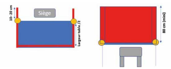
■ Éviter les séparations avec **ouvertures** (entre la table et les séparations ou entre les différentes parties de la séparation). Cette solution vise à protéger la zone respiratoire des utilisateurs de la contamination par la respiration des autres ; **éviter**, par exemple, les grilles et les ouvertures destinées à faciliter le passage du son.
